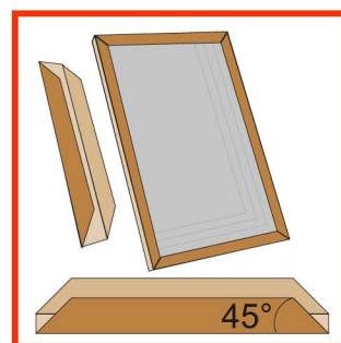
U-profil med 45 graders ändkapning bidrar till att undvika överlappning
